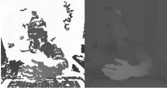
図 11 距離画像の補間処理 (左: 適用前, 右: 適用後) Fig. 11 Depth image compensation. (left: original, right: result)
