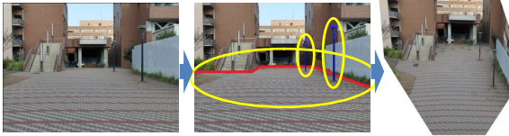
図 2: 景観画像からの 3D シーン復元の例。ユーザが折れ線と投げ縄を指定するだけで、簡易な 3D モデルが構築される。
