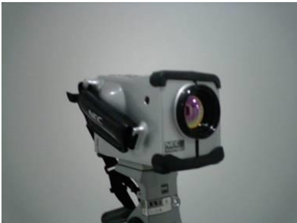
図 3 - 2 赤外線サーモグラフィ
