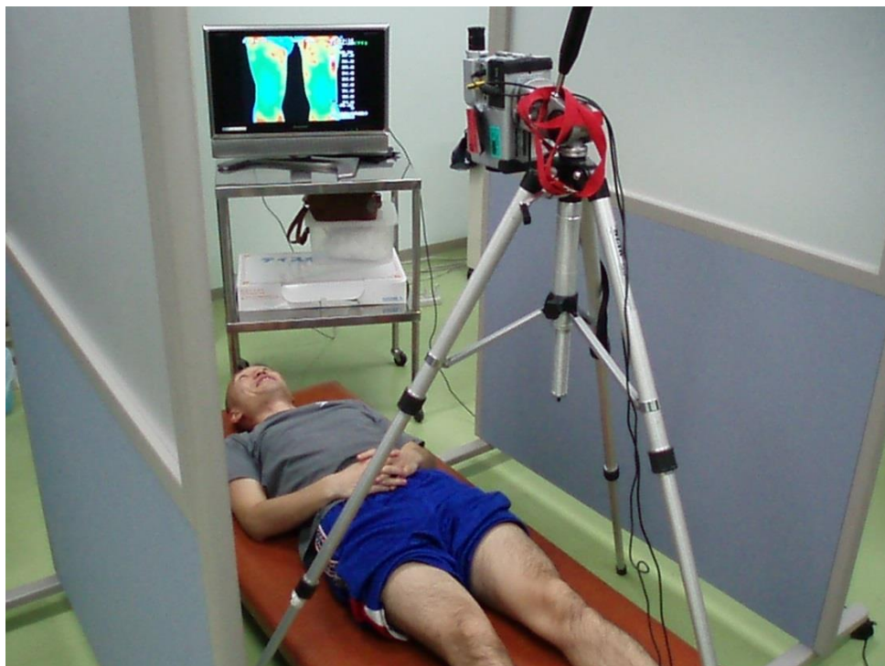
図 3 - 4 赤外線サーモグラフィの設置方法および測定環境
