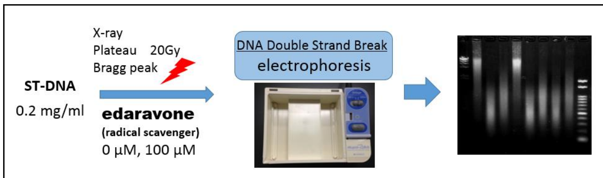
図-15 : ST-DNA を用いた放射線による DNA の二本鎖切断の実験方法略図.
