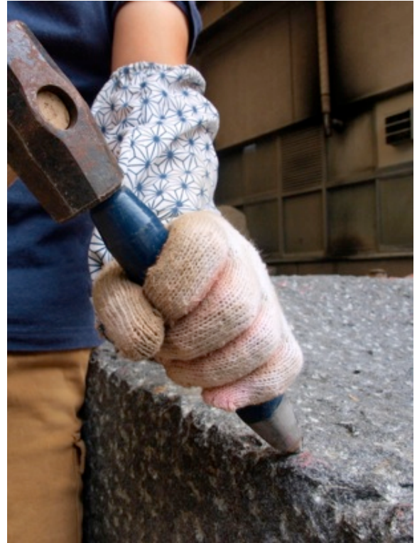
図III-2 角を残すための鑿の向き
