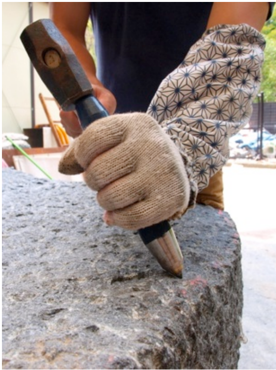
図III-1 角を落とすための鑿の向き
