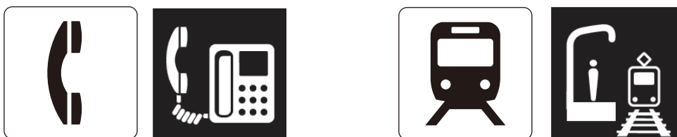
図 2-58 電話 (左)・駅 (右) の日本工業規格 JIS の案内用図記号 (背面白) 及び同規格のコミュニケーション支援用絵記号 (背面黒)
