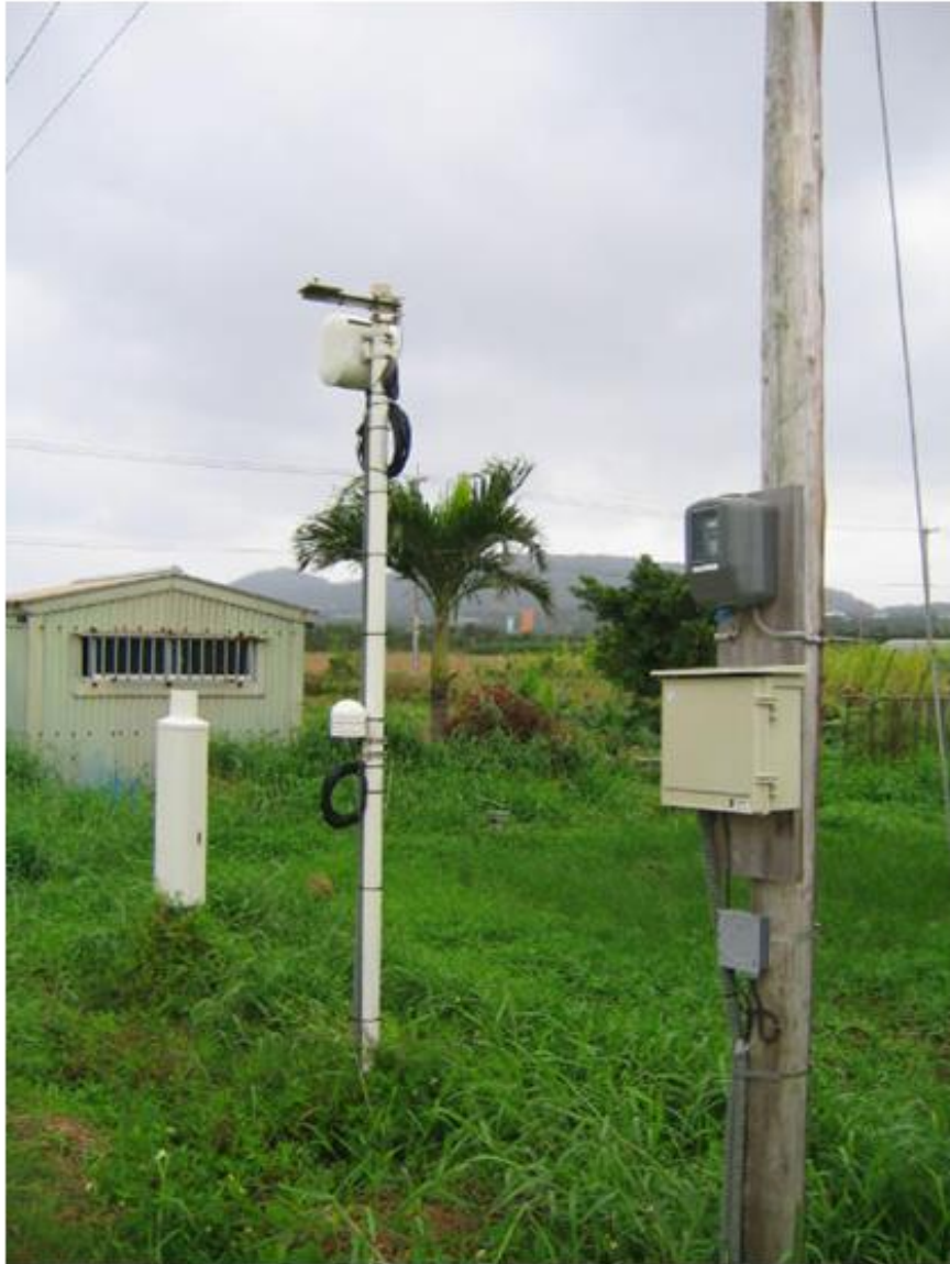
図 3-19 石垣島における夏場の内部温度実測のための実験
