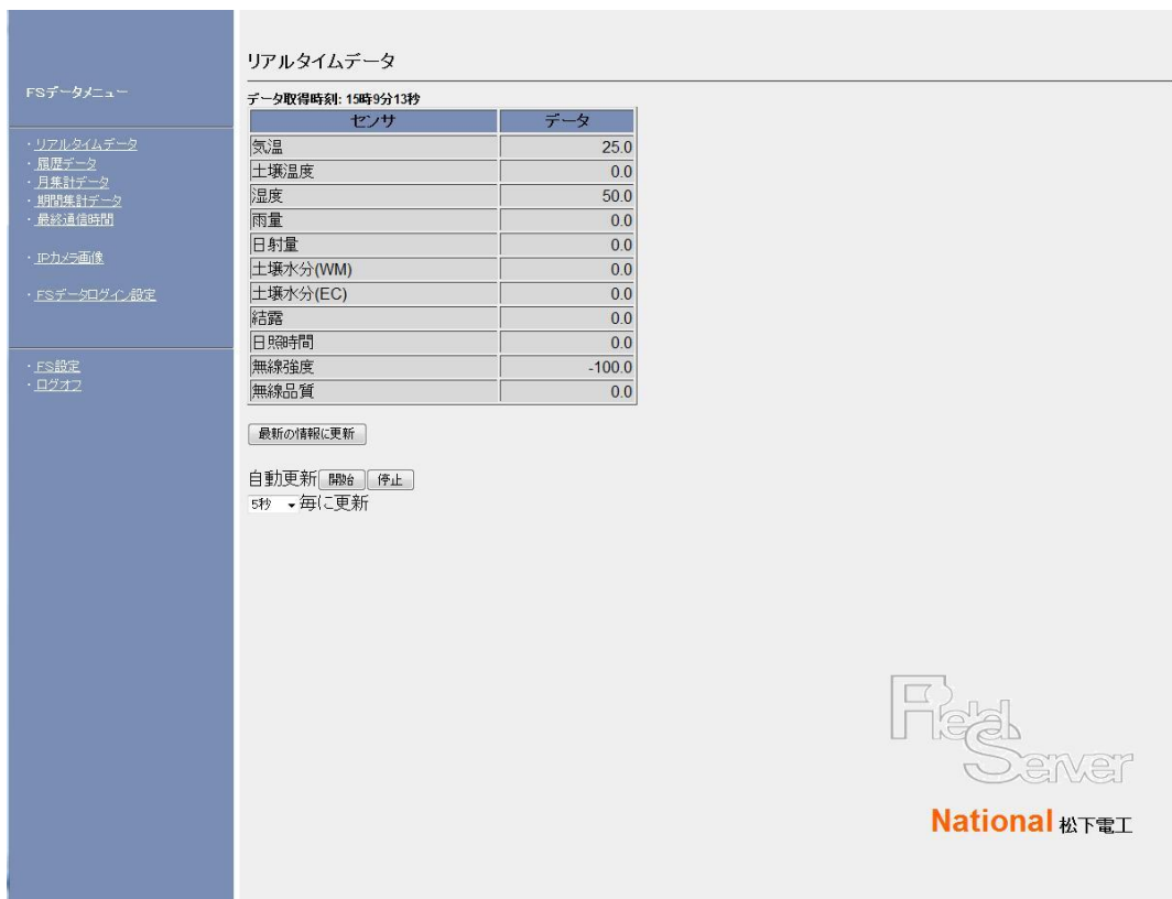
図 2-3 MP-FS1 計測データ表示画面の例
