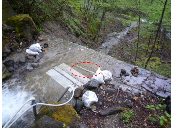
図-2.17 現地のハイドロフォンの設置状況
