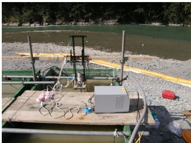
写真-6.1.1 水槽に設置した超音波分散装置
