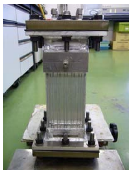
プレートフィン型熱交換器 (図 3.17 外観 と 図 3.18 フィン部拡大)
