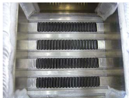
プレートフィン型熱交換器 (図 3.17 外観 と 図 3.18 フィン部拡大)
