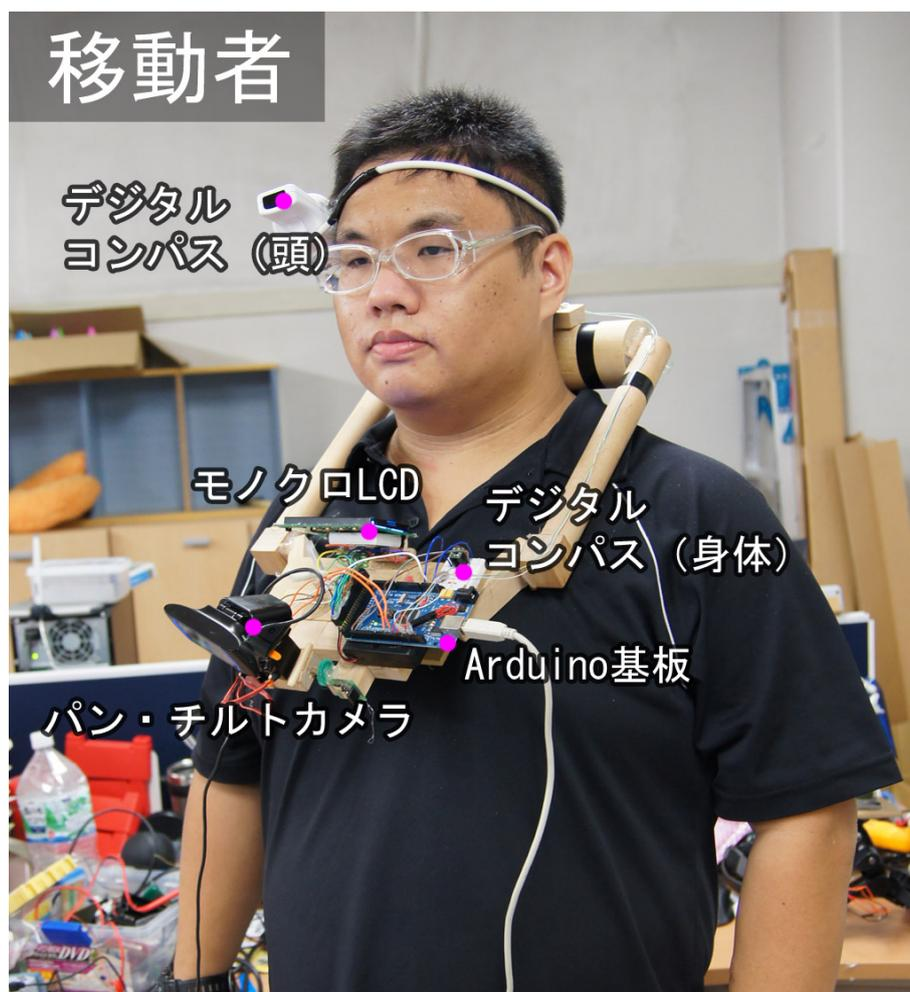
図 4.12: WithYou システム : 移動者側の装置
