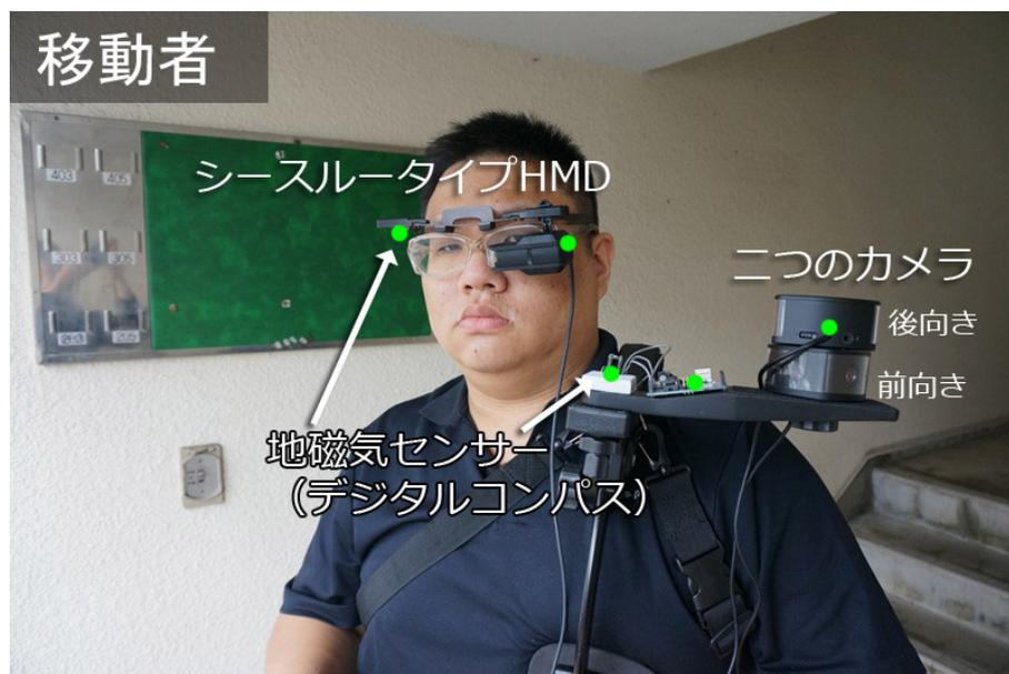
図 6.10: WithYou2 システム：移動者側の装置
