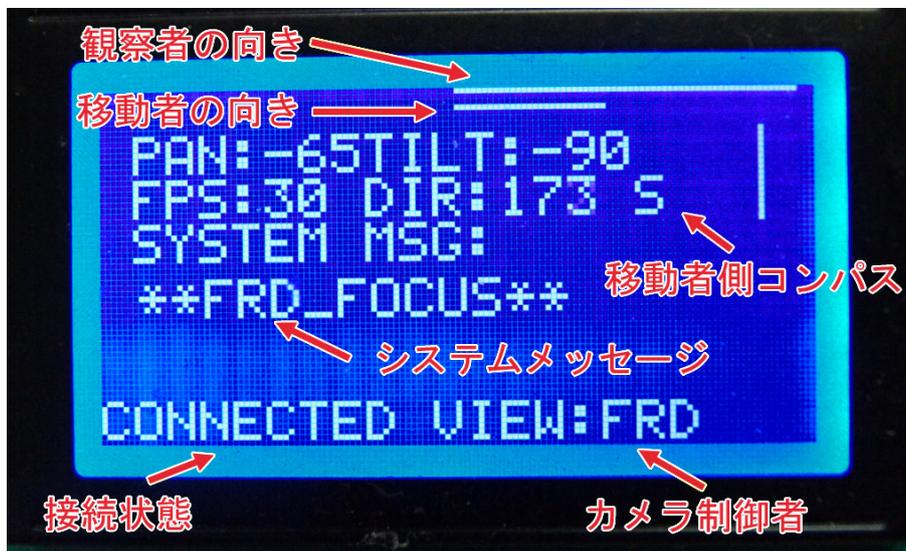
図 4.6: WithYou システム：観察者側のモノクロ LCD とその GUI
