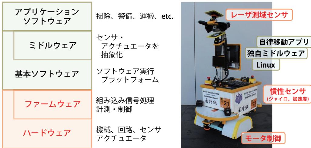
Figure. 1: 典型的な移動ロボットシステムの構成
