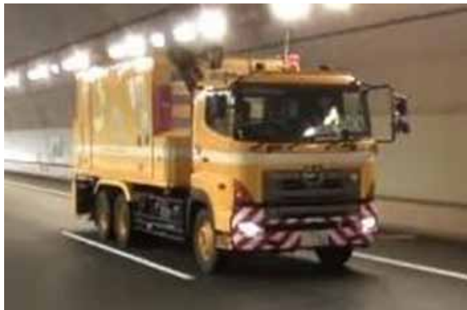
トンネル内を自動で走行する維持管理車両
