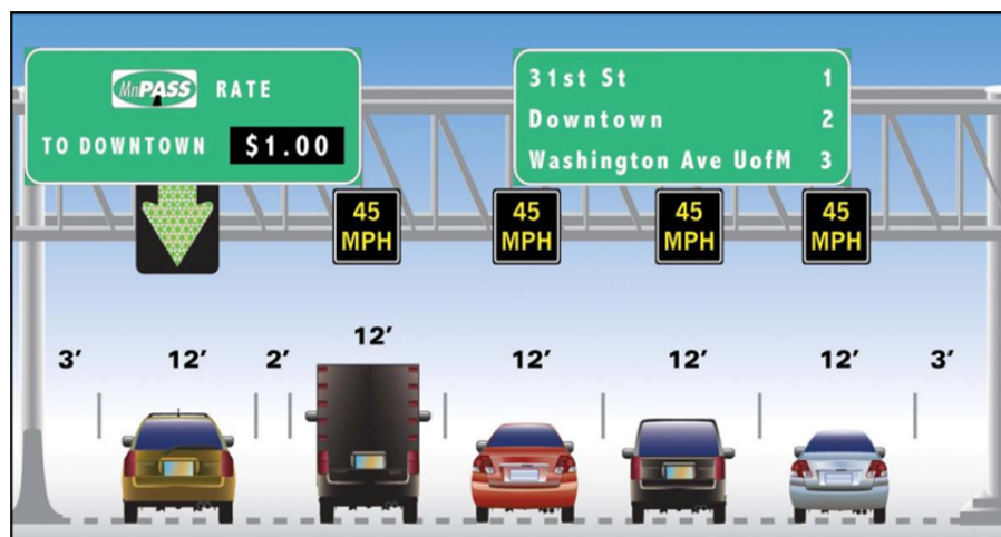
図 4.5.5 米国ミネソタにおけるダイナミック・プライシングの表示事例 (左端のレーンにおいて、混雑の程度に応じて料金が動的に変動)
