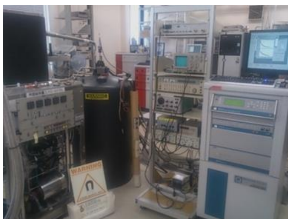
図 2-14. Quantum Design 社製 物理特性測定装置 (PPMS). 左側はヘリウムの再凝縮装置.
