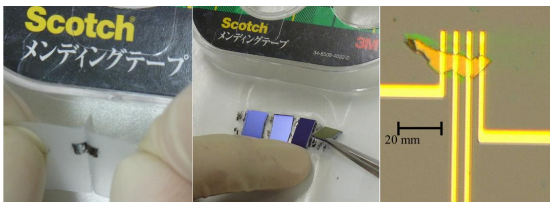
図 3-9. スコッチテープ法による薄膜作成プロセス。試料をスコッチテープで数十回劈開し，熱酸化処理した Si 基板に擦り付けることで極薄膜を得る。その後 EB リソグラフィーを用いて，四端子を作製する。
