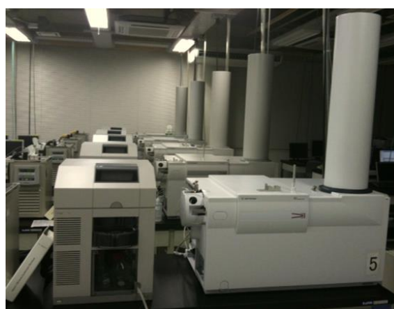
図 2-18. キャピラリー電気泳動-飛行時間型質量分析装置 (CE-TOFMS).
