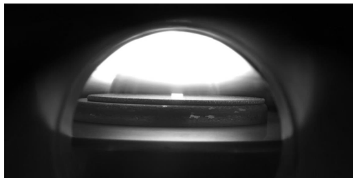
図 2.5 ダイヤモンド半導体薄膜合成中のプラズマの様子
