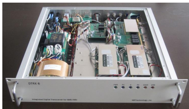
図 A4-2. デジタルトランシーバーの実装例 (DTRX6)
