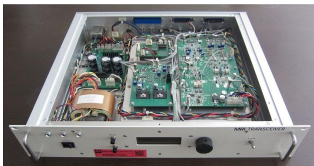
図 A4-1. アナログトランシーバーの実装例 (DTRX4-200MHz)
