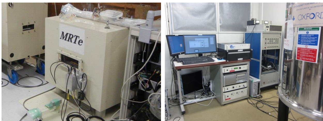
図 2-1. デジタル MRI システム. (左) 永久磁石システム, (右) 超伝導磁石システム
