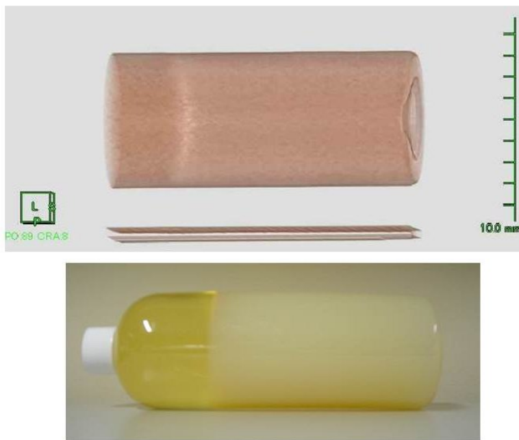
図 36 陽子線単色ビーム照射後のゲル線量計の3次元再表示画像(上)および視覚的变化(下) 陽子線単色ビーム照射後のゲル線量計の視覚的变化を下図に示す。照射範囲に一致して線量に応じた白濁が認められる。また、照射後のゲル線量計をCT撮影し、得られた画像データについて医療画像処理用ワークステーションを使用して3次元表示した画像を上図に示す。
