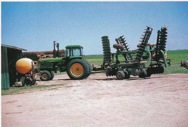
写真8 伸縮自在のディスクハロー（円盤すき）
