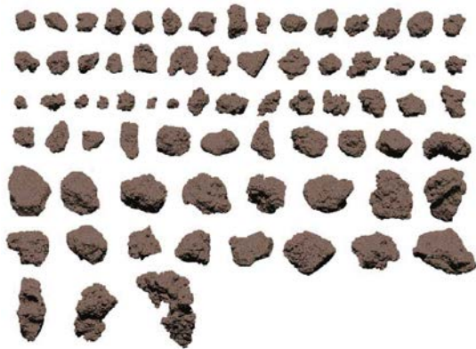
図3 CTイメージから再構築した74個の月レゴリス粒子3次元画像
