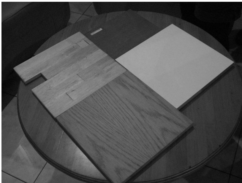
写真 5-2 B 社のランバーコアボード(左上)と化粧貼集成材(右上) (2009 年 6 月著者撮影)
