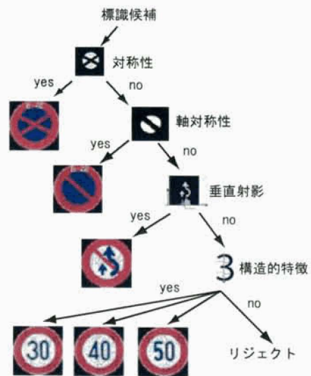
図 2: 識別決定木。速度規制の構造的特徴は、30Km のみを示している。
