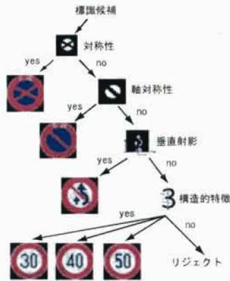
図 8 識別決定木。速度規制の構造的特徴は、30km/h のみを示している。詳しくは本文を参照のこと。
