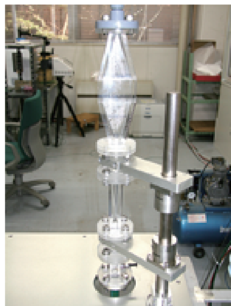
ベンチュリ管式気泡発生装置
