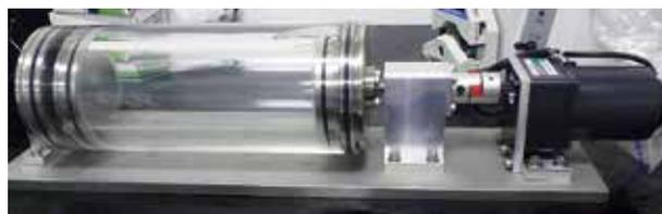
図2 製作したマリンスノー発生装置 (モーター部は後付)
