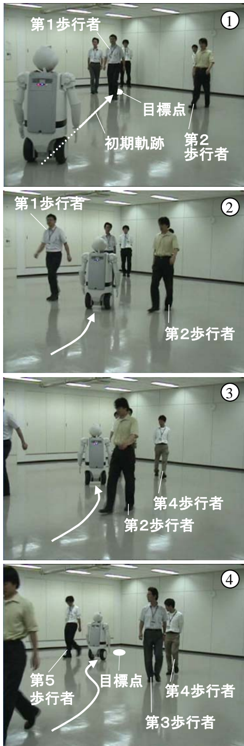
図4.7 EMIEWを用いた衝突回避実験
