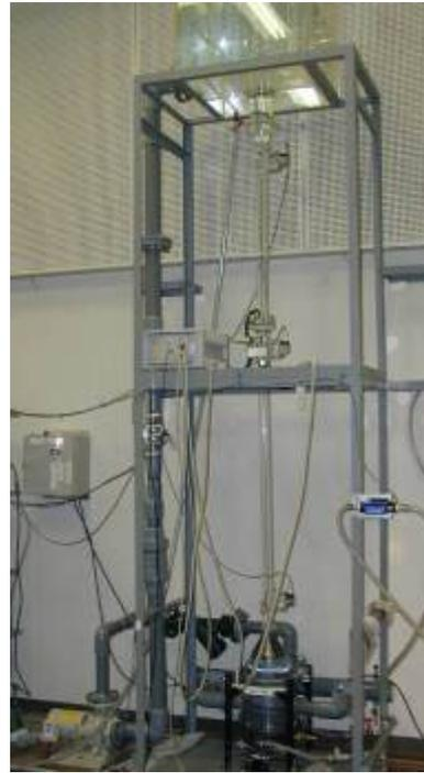
図 3.7: 垂直管二相流実験装置
