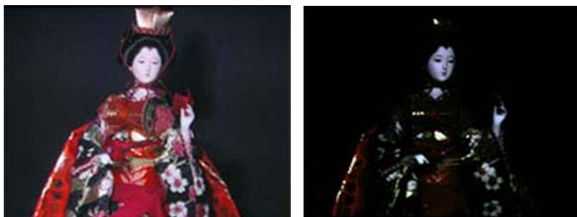
図 6 . HARP 受像管と CCD カメラの比較
