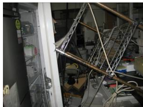
図 13. アングル棚の落下
