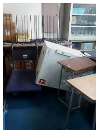
図 6. 2B 棟 3 階学生実験室の落下した恒温器と改善例
