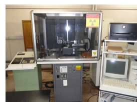
図 4. 防 X 線カバー脱落及び修理後
