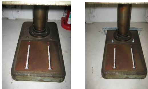
図 25. 移動したボール盤(左)とボルト固定後(右)
