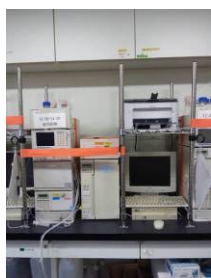
図 14. 実験機器と冷蔵庫の固定例
