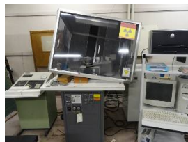
図 4. 防 X 線カバー脱落及び修理後
