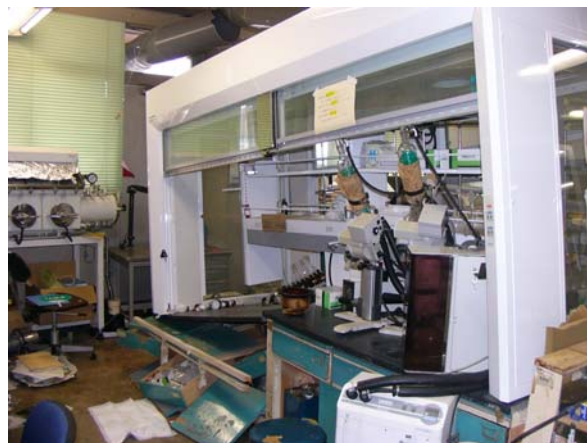
図 1a. 自然系学系棟 C 棟 5 階の被害 実験台が崩壊（写真提供：木越 英夫 教授）
