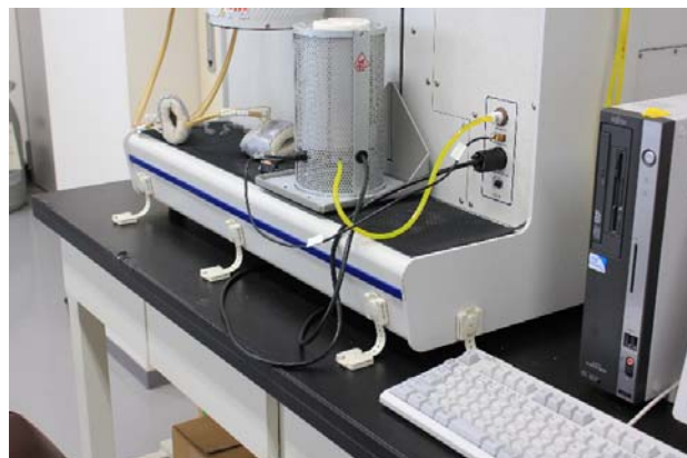
図8. 自動吸着量測定装置 実験台と装置の間に耐震用ゲルを挟み、バンドで実験台に固定
