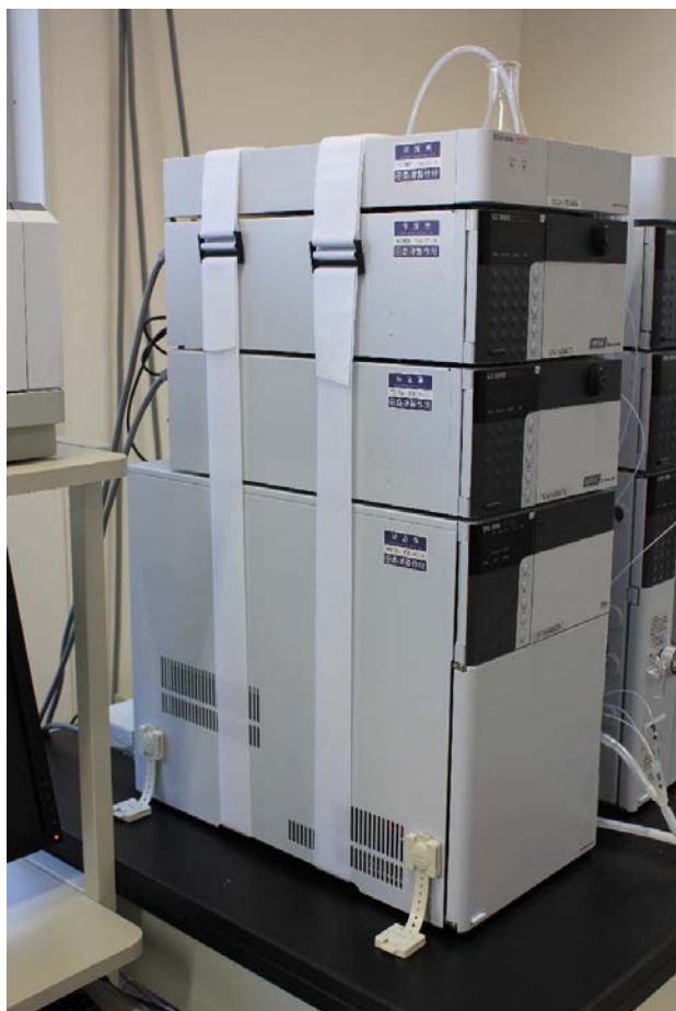
図10. 液体クロマトグラフの固定 各ユニットをマジックテープでまとめてくくり、装置と実験台の間に耐震用ゲルを挟み、バンドで実験台に固定
