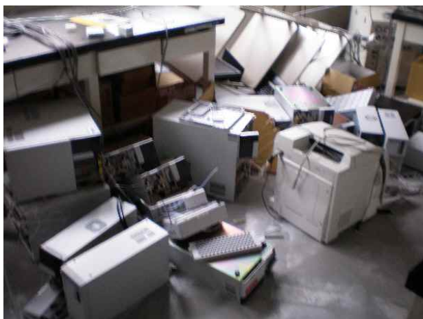
図7. 実験台から転落した液体クロマトグラフとパソコン
