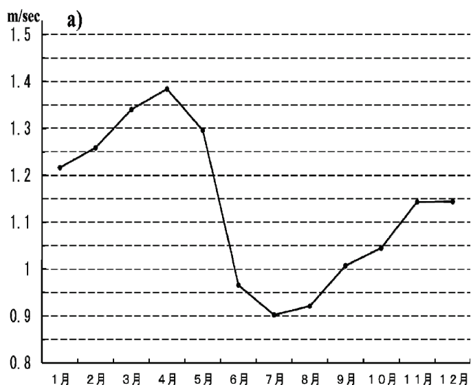
図9. a) 1998-2010年の月別平均風速および b) 季節別の風向頻度図
