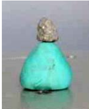
(2) 砕石粒子測定状況 6) (粘土による固定)
