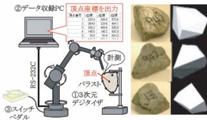
図 2.28 デジタイザを用いたバラスト3次元形状測定方法 41)
