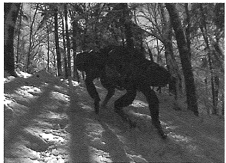
図1. Marc Raibert, Kevin Blankespoor, Gabriel Nelson, Rob Playter and the BigDog Team, "BigDog, the Rough-Terrain Quaduped Robot," Fig 2. 雪に覆われた坂を昇るテスト中の「ビッグ・ドッグ」(ボストン・ダイナミック社の許可のもの掲載)
