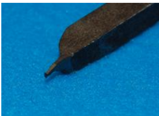
図4. 自作した溝入れ用のバイト
