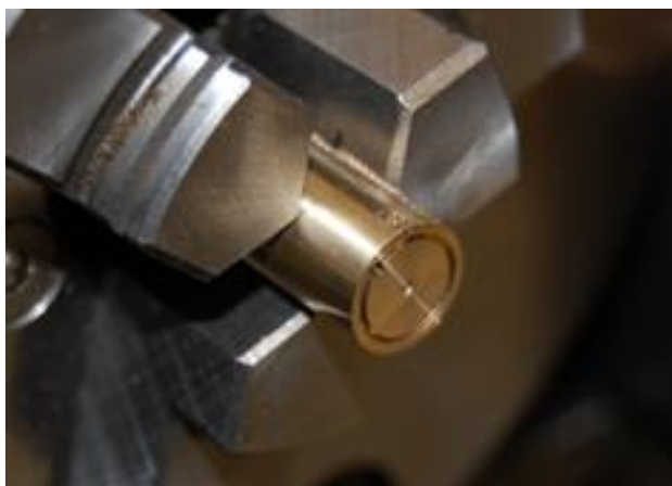
図 6. 溝入れ、ネジの下穴、ステンレスパイプ差込口の加工が完了したところ
