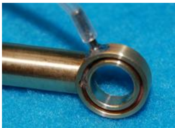
図 9. 完成した固定器具;チューブコネクタとなるステンレスパイプがハンダ付けされている
