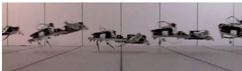
図10：小型2脚滑走ロボットによる俊敏走行の実現（連続写真の重ね合せ）
