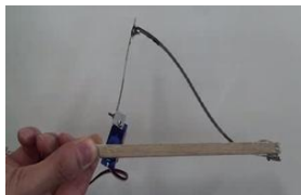
図3：異方性弾性点型（尖っている部分は蝶番で、異方性弾性点である）
