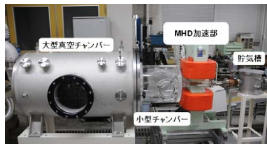
図 10 MHD 加速部付き誘導結合型高周波プラズマ噴流装置の流路構成写真
