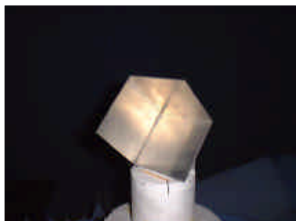
図 3-2 ミリ波帯 (60.5GHz) における 3 面直交リフレクターの RCS (偏波 VV, -面, c=100\text{mm} )
