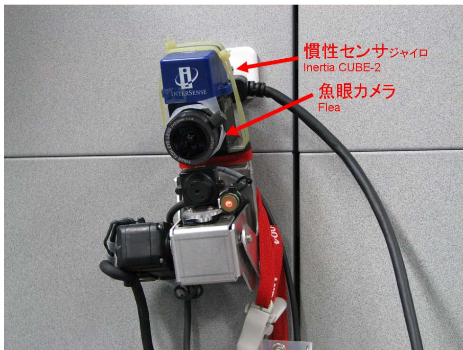
図 5.2: 周辺視野の獲得に魚眼レンズを用いたシステム
