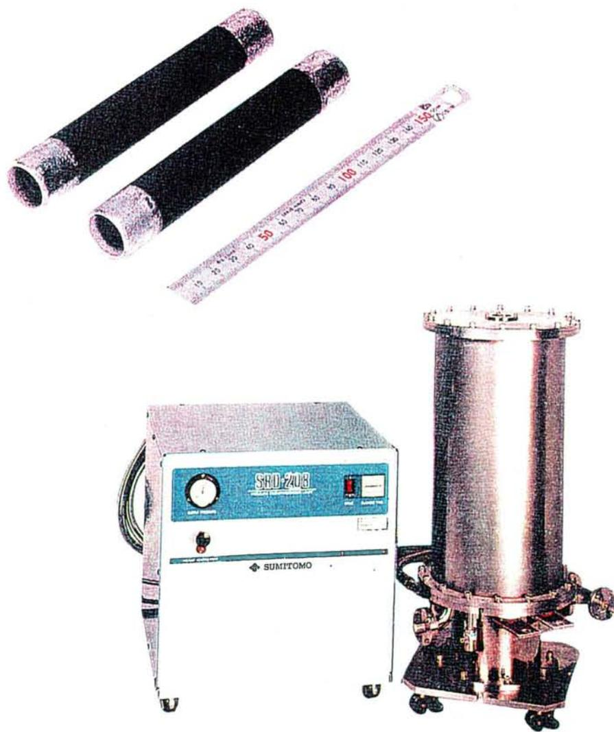
Fig.3-1 ヘリウムフリー超伝導マグネットと酸化物超伝導電流リードの外観写真
