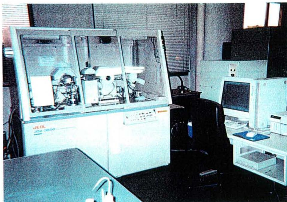
Fig.4-1-5 X線回折装置の外観写真
