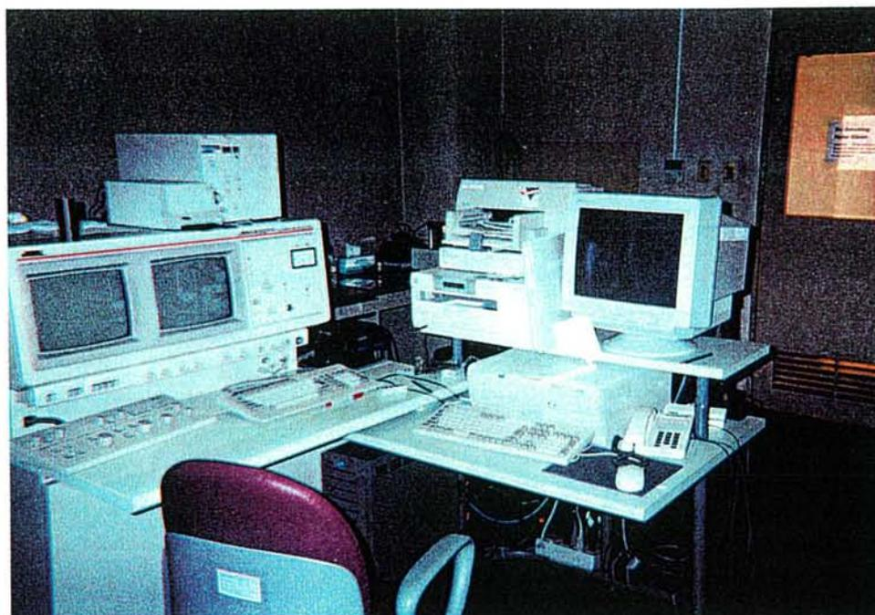
Fig.4-1-6 走査型電子顕微鏡(Scanning Electron Microscope)の外観写真
