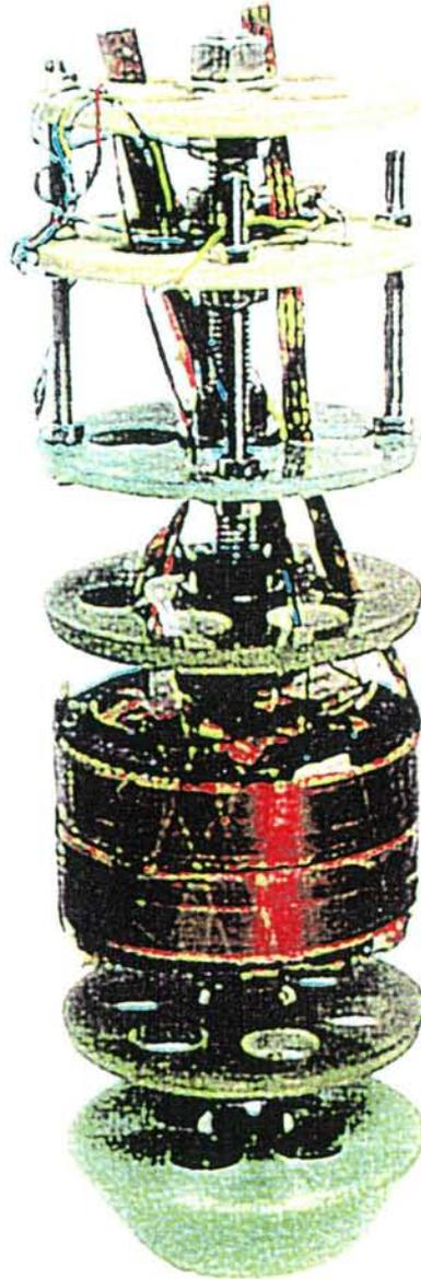
Fig.1-16 Dip-coat 法を用いた線材によって作製されたコイルの外観写真
