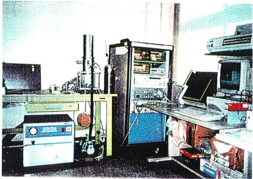
Fig.2-4 臨界温度( $T_c$ )測定装置の外観写真
