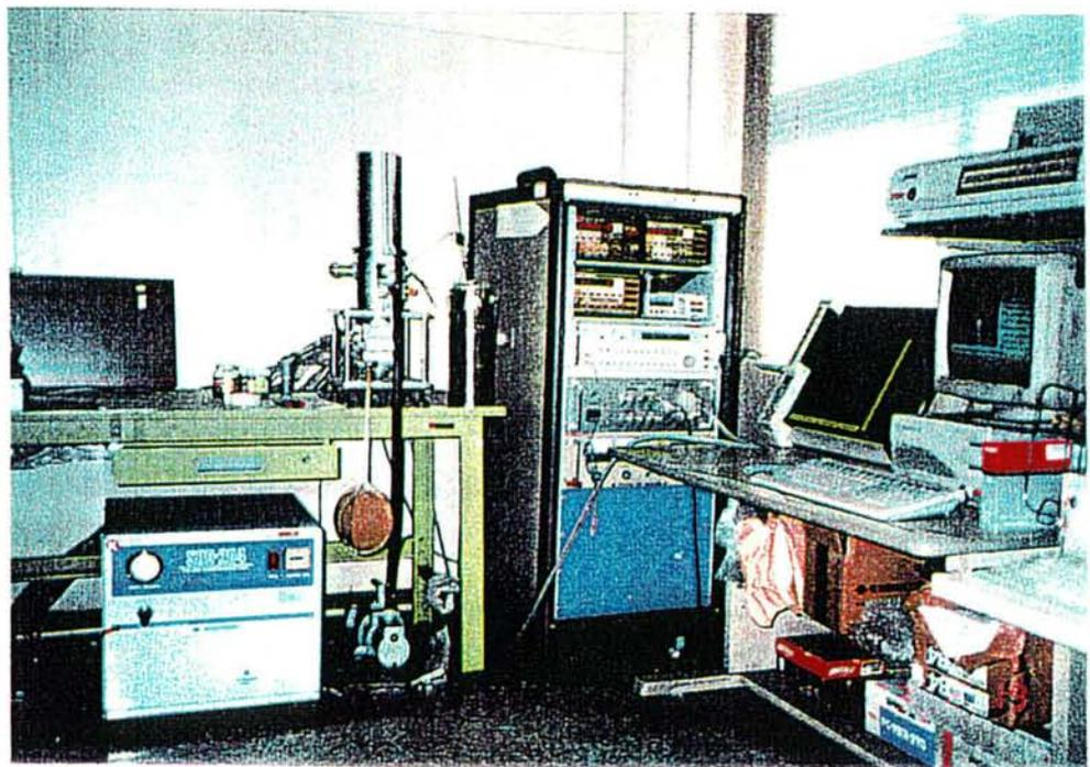
Fig.4-1-4 交流帯磁率測定装置ユニットの外観写真
