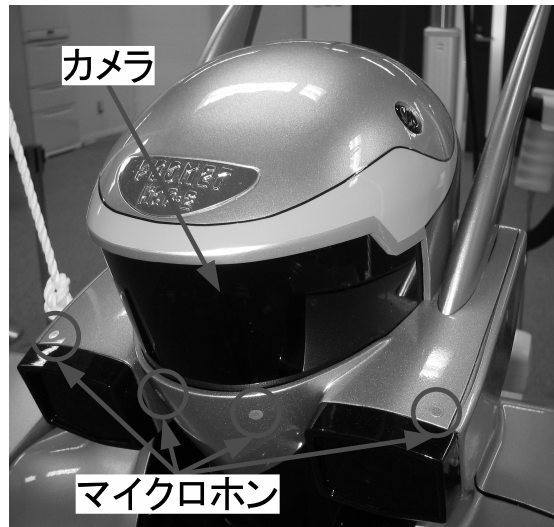
図 4.5: 実験に用いたマイクロホンアレイとカメラ
