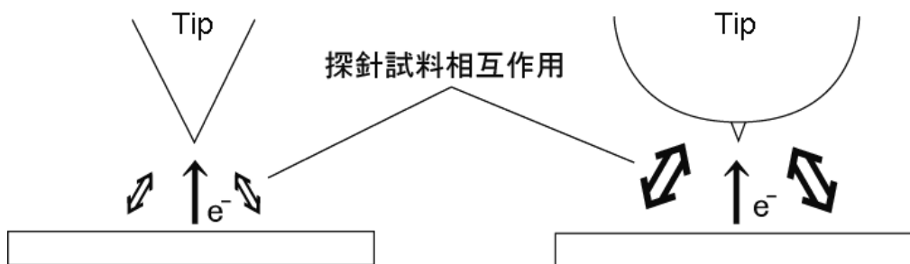
図 5.17 STM/FE 計測前の探針 (a) と計測後の探針 (b)
