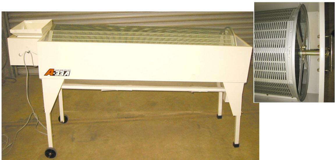
写真 3-1-2 回転式選別機（タイガーカワシマ製 A33）
