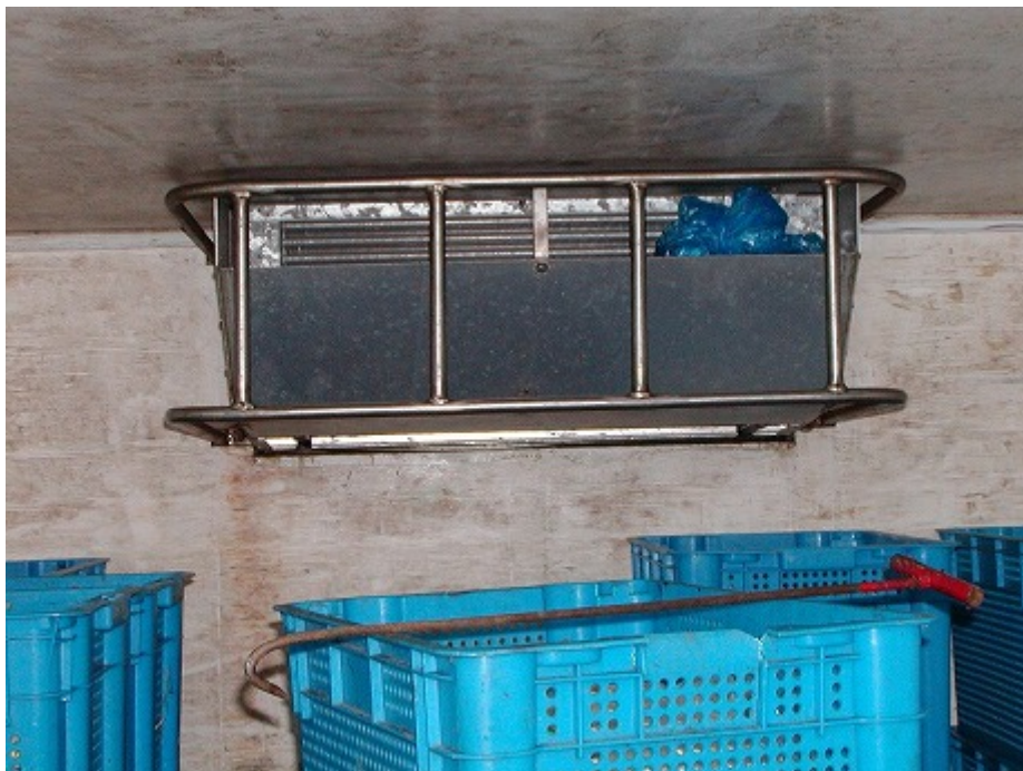
図 2-21 冷凍機を備えた輸送車両の庫内（上海市曹安市場）
