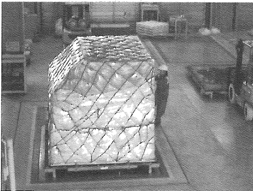
写真3 ULD 組付作業の様子
