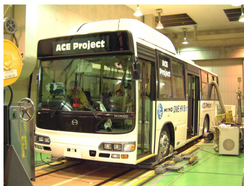
図 2.3.2-1 ACE-B2 の C/D への設置状況
