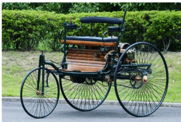
図 1.2.2-2 カール・ベンツによる世界初のガソリン自動車 [21]
