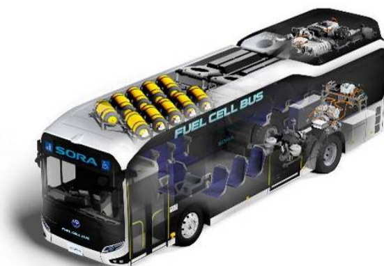
図 1. 2. 4-4 トヨタ自動車 FC バス「SORA」の透視図 [56]
