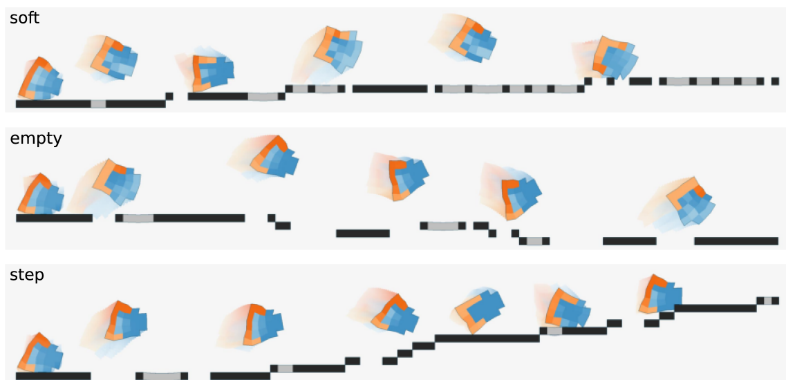
図 6.4: 環境の変化で得られた特徴的な 3 つの環境と、それらに全てに適応した 1 つのロボット設計。
