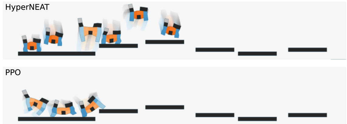
図 5.5: PlatformJumper-v0 タスクに対して、Hand-Designed 設計の制御を、HyperNEAT と PPO によって最適化したときの動作の様子。
