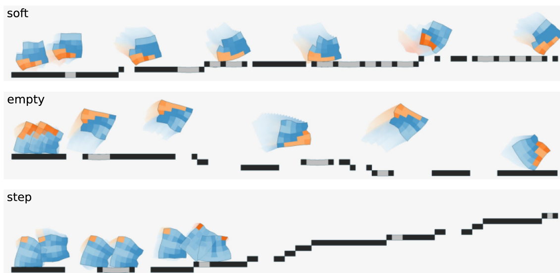
図 6.6: 固定環境に対する設計最適化で得られた最適なロボット設計と動作。
