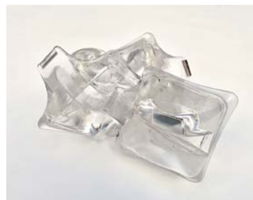
図4 HOW TAPE 成型後の乾燥不足による変形で製品同士がくっついた様子
