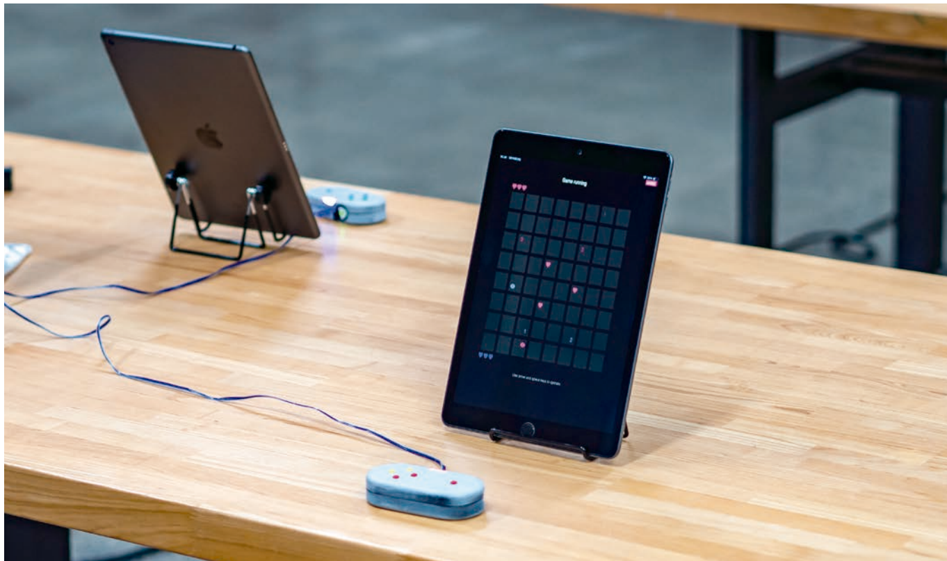
図1 制作したゲームデバイスの外観。コントローラから採取された脈波データがそれぞれの画面にゲーム内容と合わせて表示される。
