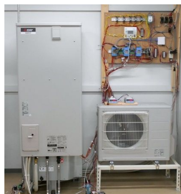
図3 ヒートポンプ給湯機実機検証装置
