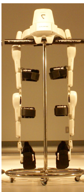
図1：ロボットスーツHAL福祉用
