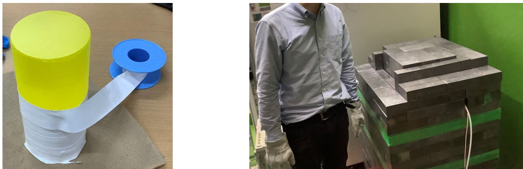
図 28: (左) 金研で作製した大型 GFAG 結晶に反射材のテフロンテープを巻いているところ。(右) 神岡地下実験室の鉛シールドで 7 月に行った実験の様子。
